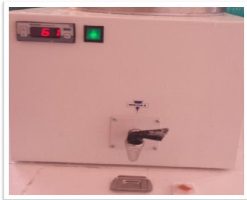
Figure 14: L'imprégnation par la paraffine et la mise en bloc.
