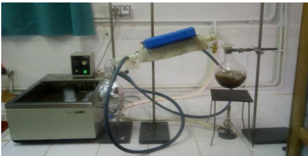
Figure 7. Dispositif d'hydrodistillation utilisé pour l'extraction des huiles essentielles
