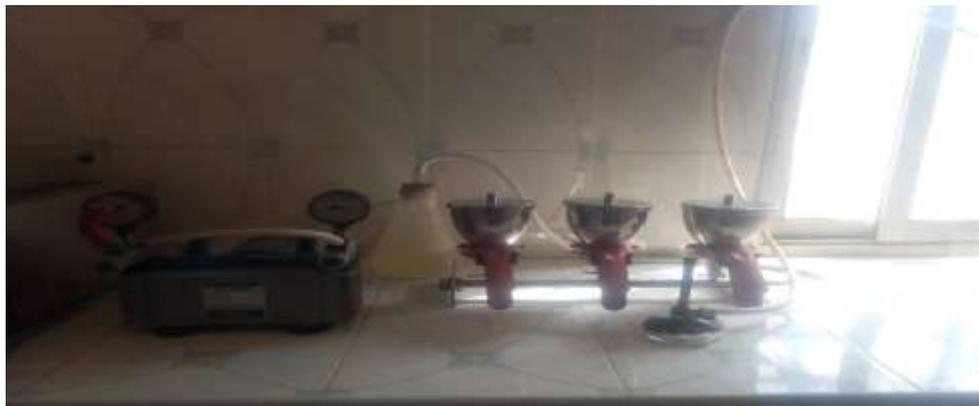
**Figure 14 : Rampe de filtration**
