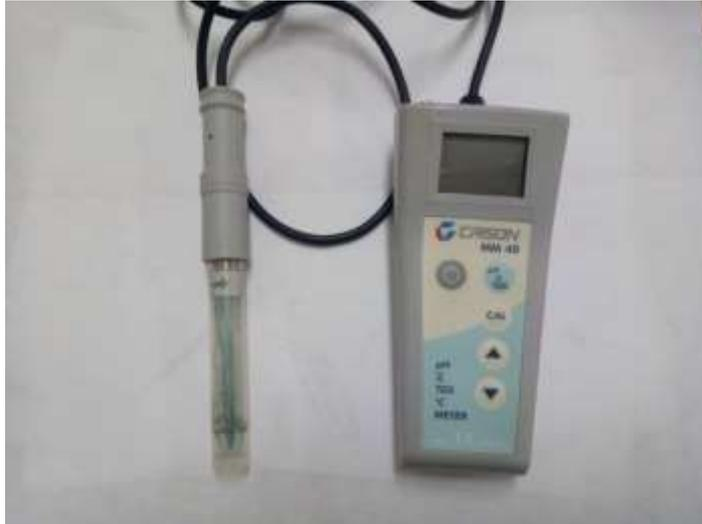
**Figure N° 06:** Appareil multi paramètre MM40 CRISON (Cliché SAIDI, 2019)
