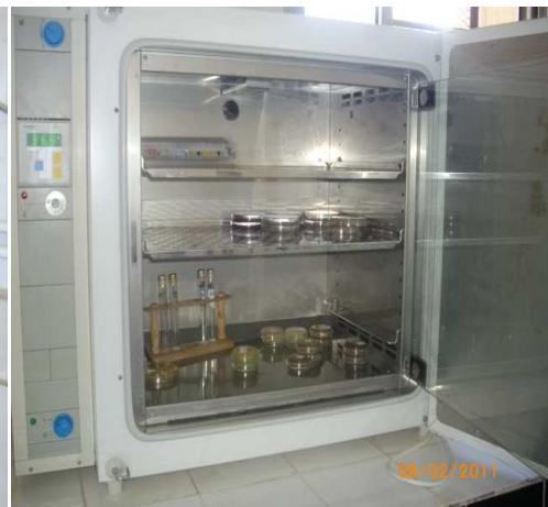
Figure 12 : Etuve réglé à 37°C
