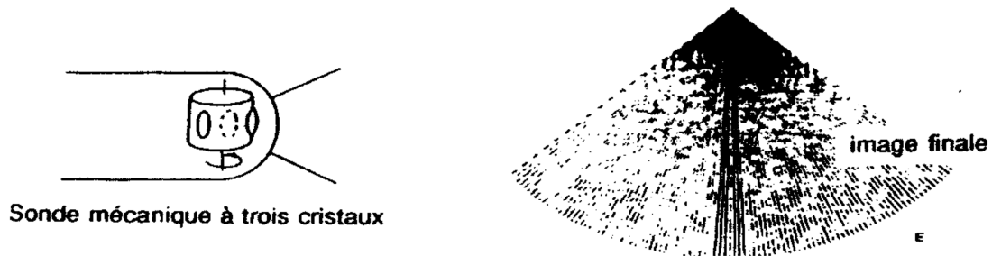
Figure09 : structure et fonctionnement d'une sonde sectorielle.
