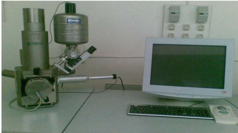
Figure II-5: Représentation schématique du MEB
