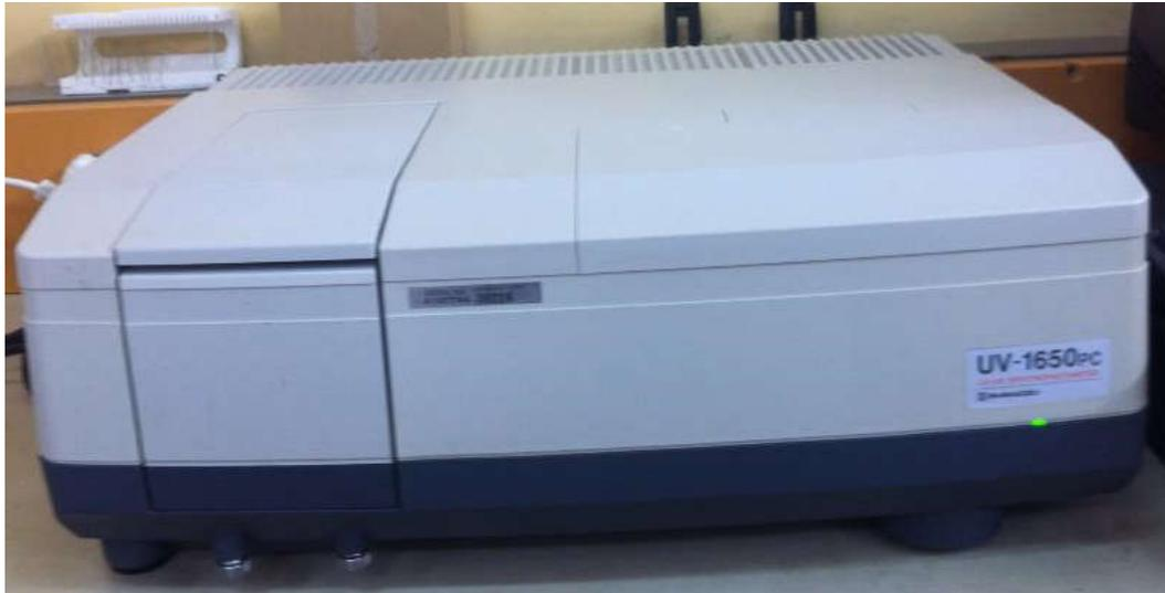
**Figure II-2:** Spectrophotomètre UV-Visible de marque SHIMADZU UV-1650-PC à double faisceaux.
