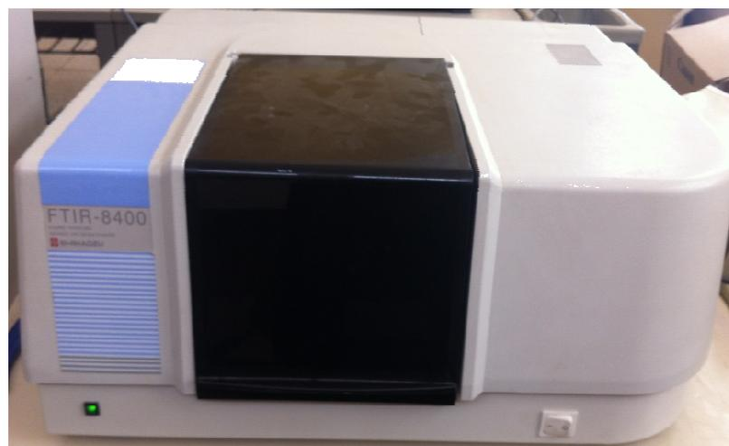
**Figure II-10:** Spectrophotomètre SHIMADZU FT-IR-8400.
