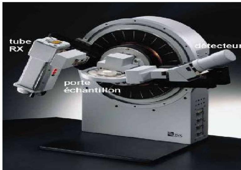
Figure II-8: Diffractomètre Bruker-AXS, type D8
