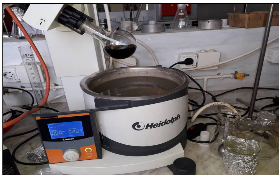
Figure 16: évaporation de l'extrait des anthocyanes par un rotavapeur
