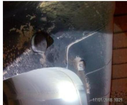
**Fig. II-19 :** Desserrage des plaques du blindage fond d'entrée
