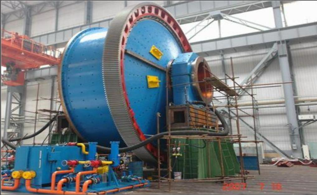
Fig. I-13 : Broyeurs à semi-autogènes
