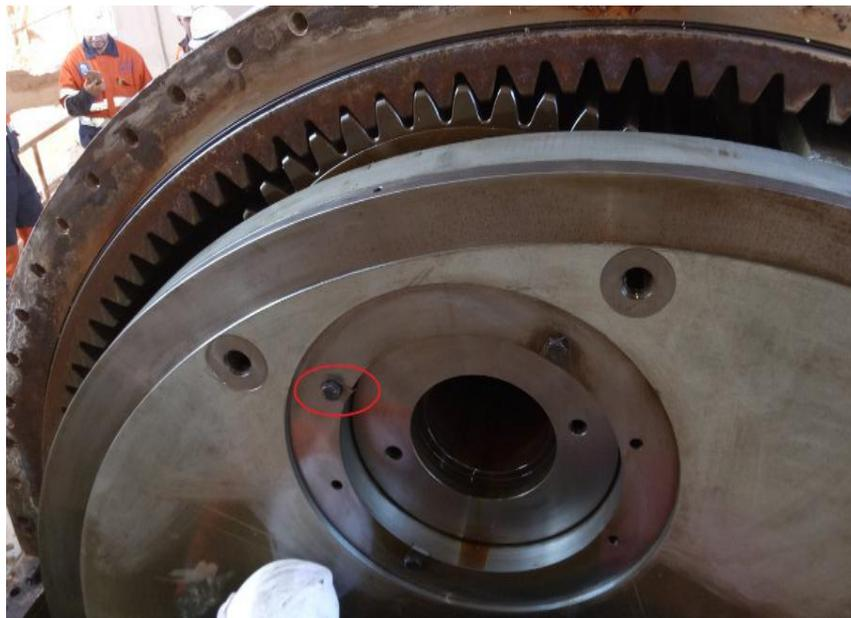
**Fig. II-23 :** Usure des dents du réducteur et cisaillement des vis de fixation
