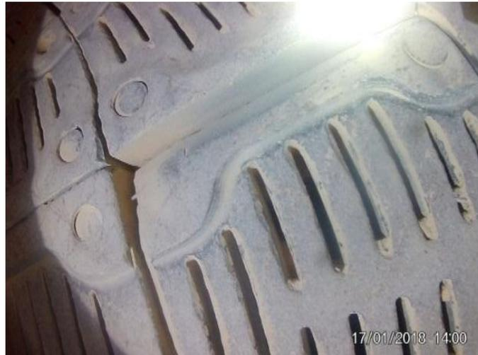
Fig. II-20 : Usure des plaques de la cloison
