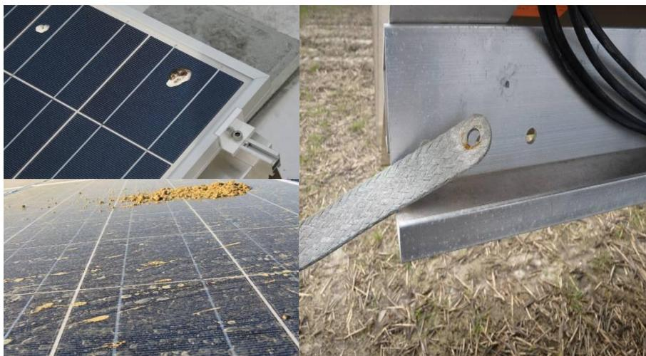
**Figure IV.10** : Inspection visuelle de modules.
