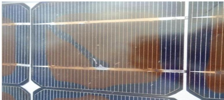
**Figure IV.4:** Fissure de la cellule [44].
