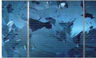
Figure II.9 : Cellule polycristallin.
