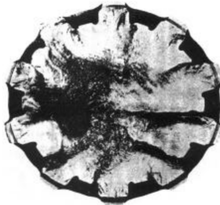
Figure I.3 Exemple de faciès de ruptures de pièces sous sollicitations combinées [1].
