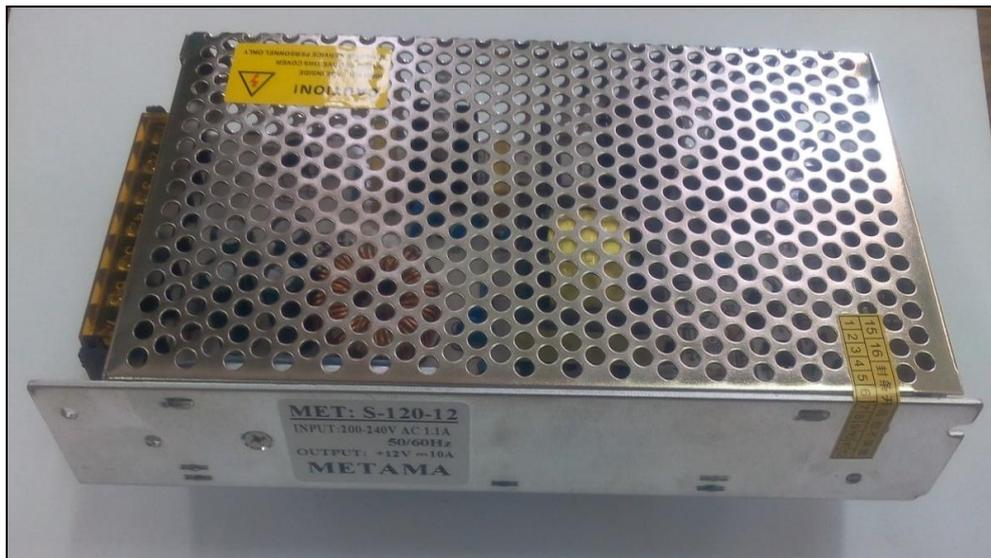
**Figure 3.4** : Alimentation électrique pour cartes-contrôleurs.
