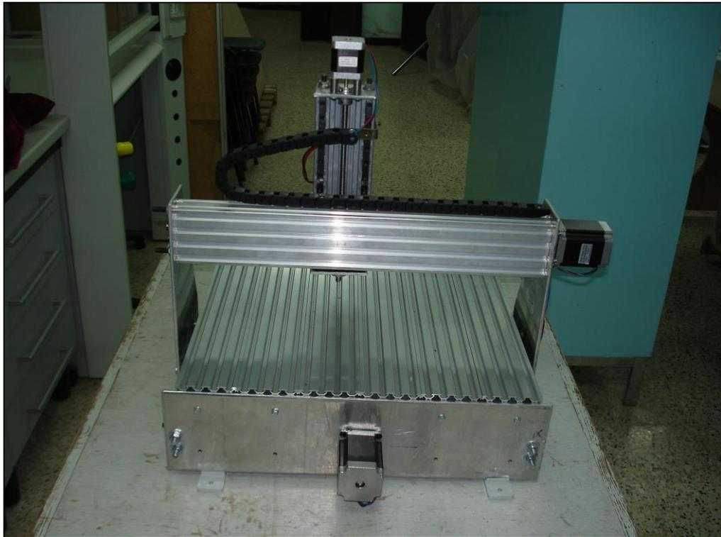
Figure 3.20 : Bâti de la machine-outil réalisée (Vue de derrière).
