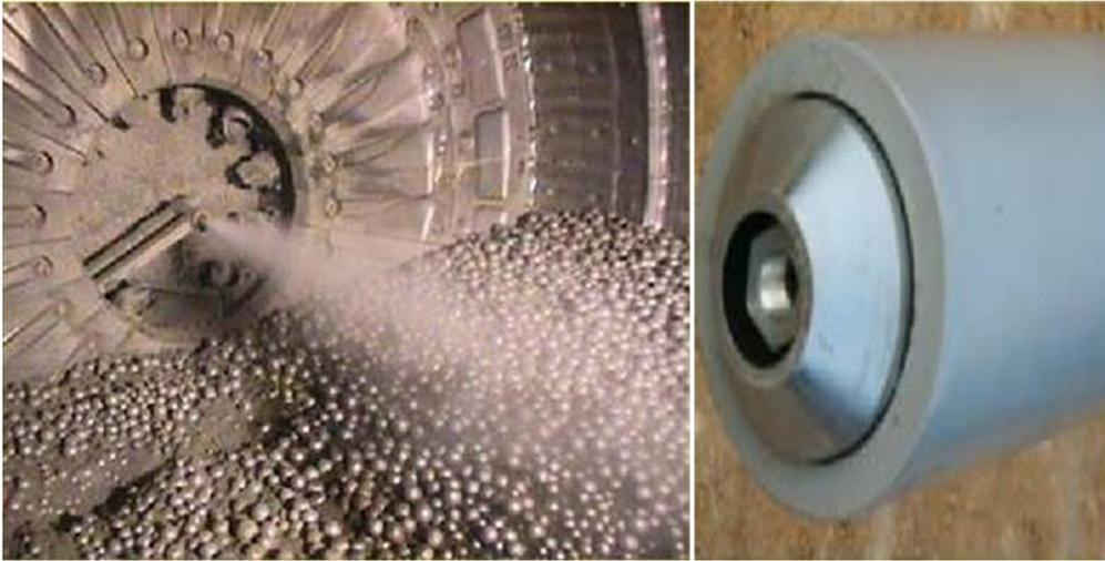
**Figure I.25 :** Injection d'eau.
