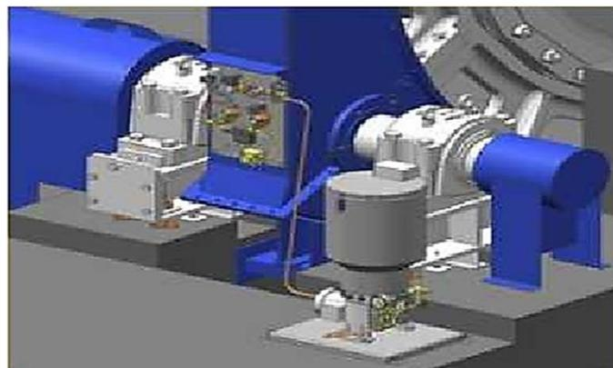
**Figure I.23 :** Pompes de lubrification (haut pression et basse pression).**I.3.13. Ventilation du broyeur** (Figure I.24)
