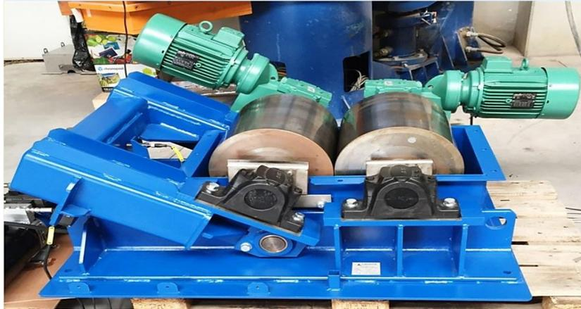
**Figure I.5 :** Broyeur à cylindres
