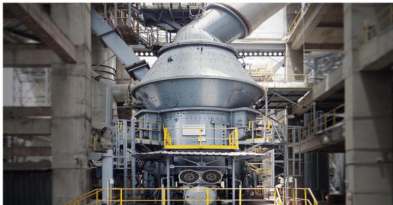
**Figure I.6 :** Broyeur à galets
