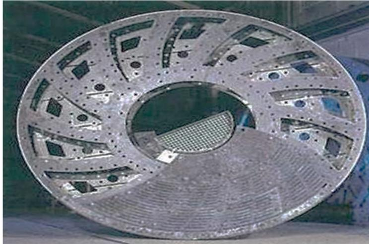
**Figure I.16 :** Cloison de sortie [3]
