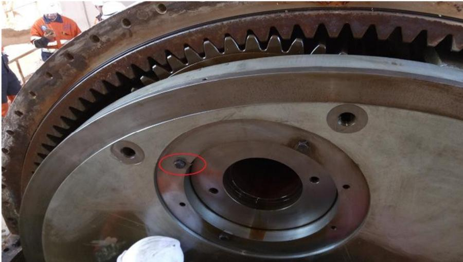
**Figure I.31 :** Usure des dents du satellite
