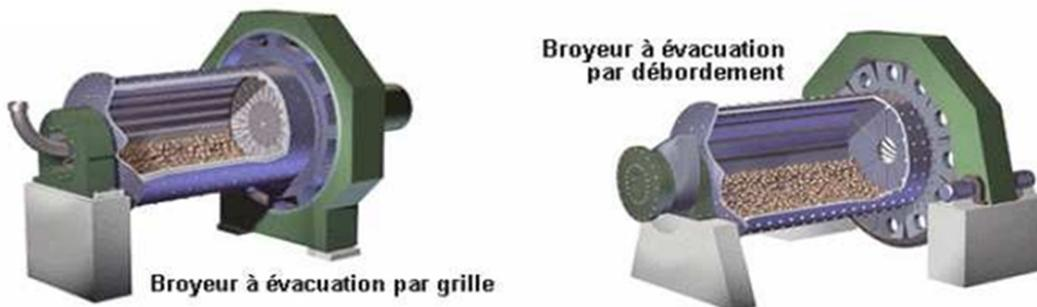
Figure I.2 : Broyeurs à boulets
