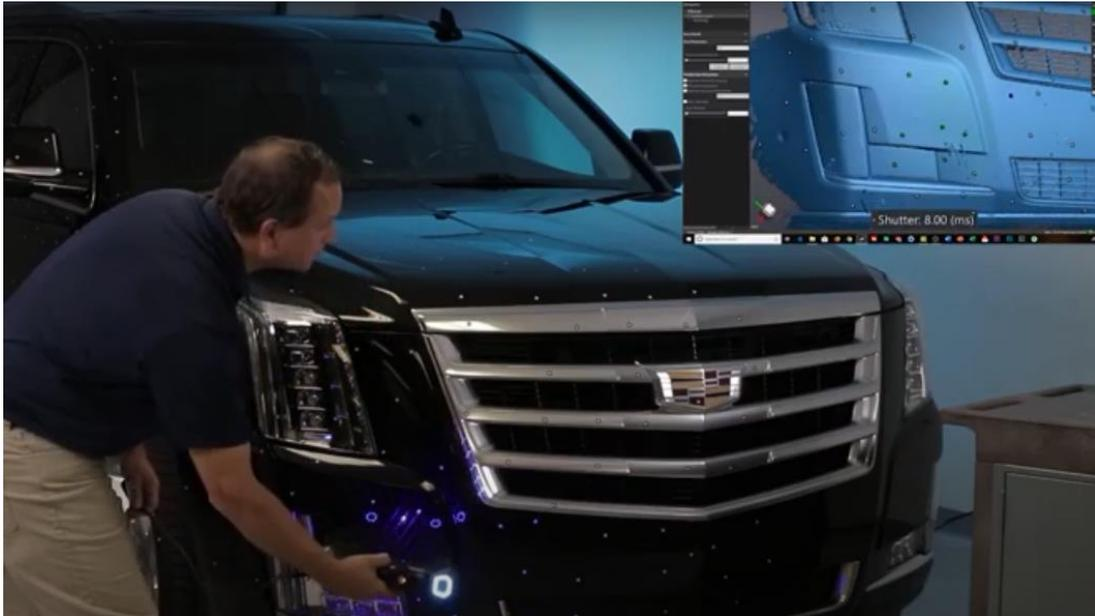
Figure II.22 : Scannage de la surface du véhicule. [40]
