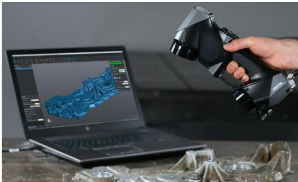
**Figure II.10** : Un exemple de scanner laser [33]
