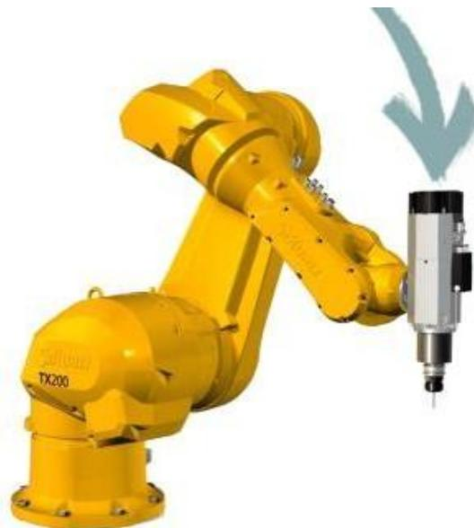
**Figure.I.17** : Tête d'usinage sur un bras robotisé [13]
