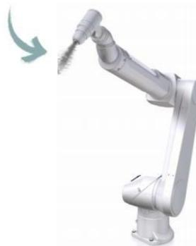
**Figure.I.20** : Pistolet de peinture sur un bras robotisé [13]
