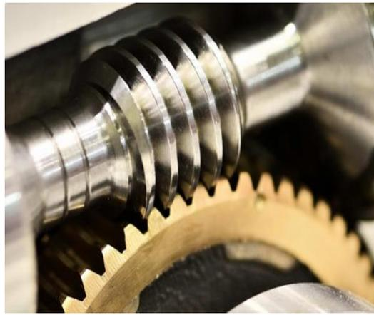
*Figure 1.9* Exemple d'une paire d'engrenages à vis sans fin. [6]
