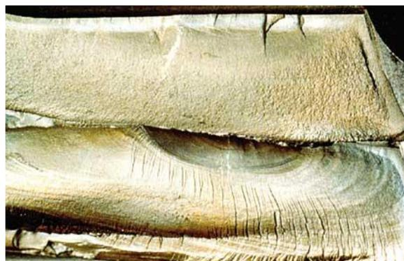
*Figure 1.10* Surface de fracture par fatigue de flexion de dents d'engrenage .La dent supérieur a plusieurs origines de l'échec[7]
