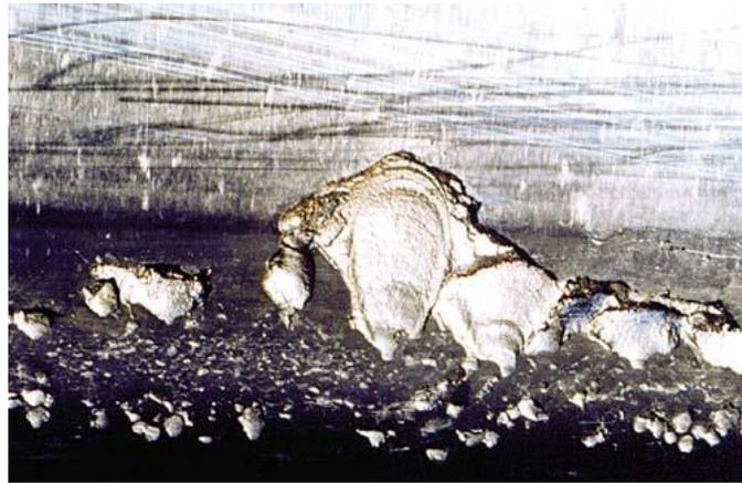
**Figure 1.12** Rupture par fatigue (piques) dans le contact. Surfaces d'une dent d'engrenage. Les marques de plage sont visibles dans certaines des plus grandes fosses [7]
