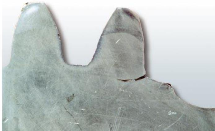
**Figure 1.11** Fissure de fatigue dans le congé de racine de dents d'engrenage[7]
