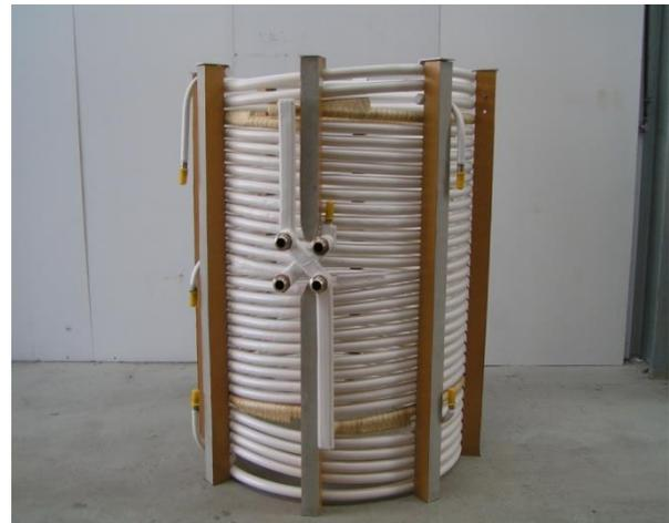
**Figure I-7:**isolation de bobine de four à creuset [8].
