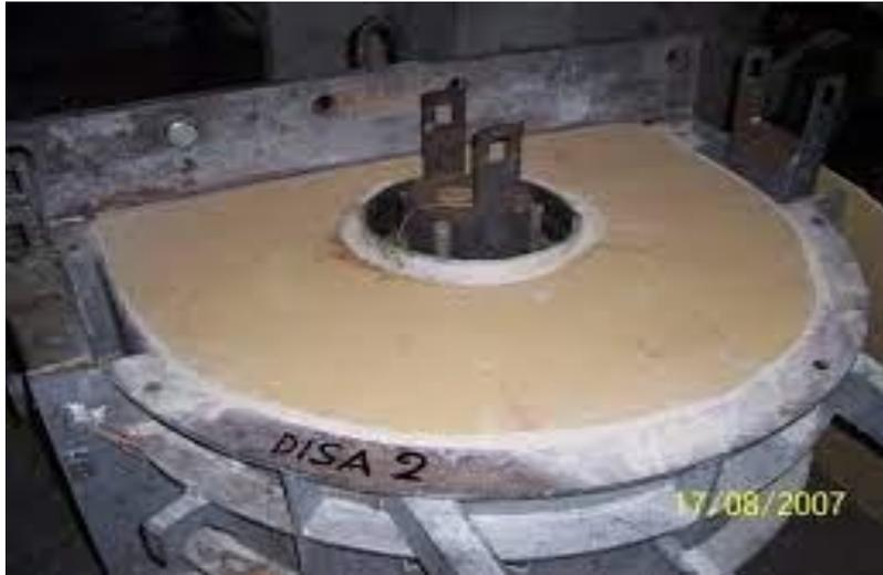
**Figure I-8** : four à induction à canal [8].
