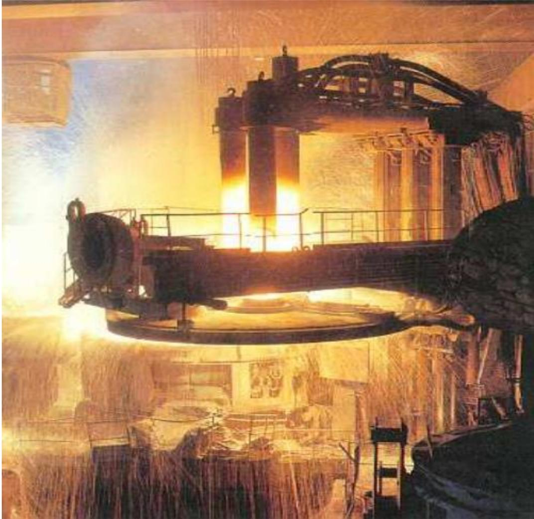
**Figure II-3 :** Four à arc à courant alternatif.
