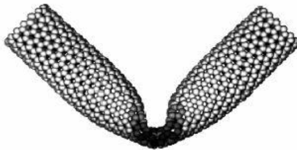
Figure.II.2. Contrainte mécanique qui induit une flexion dans un nanotube de carbone
