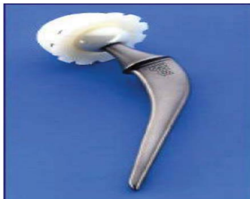
Figure II.8 : P.T.H avec cupule en polyéthylène, tête en céramique et tige en acier inoxydable
