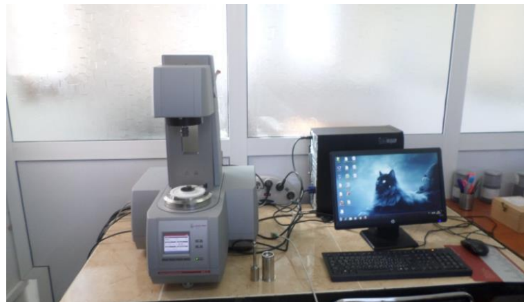
Figure III.6. MCR 302 raccordé à un PC.
