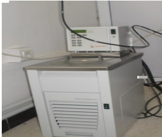
Figure III.4. Bain à circulation du MCR.
