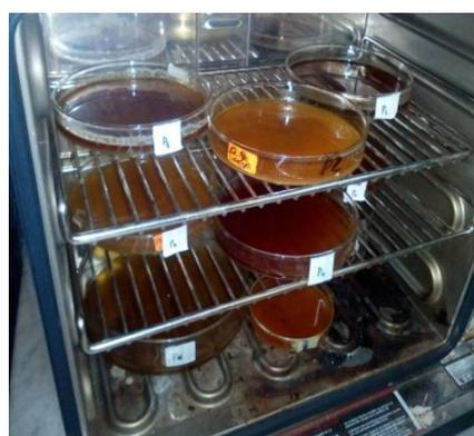
**Figure N°IV-15:** Evaporation de l'éthanol par étuve.
