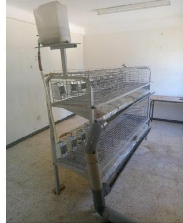
**Figure N°IV-24 :** Cage métallique superposée équipée conçues spécialement pour l'élevage de lapin .
