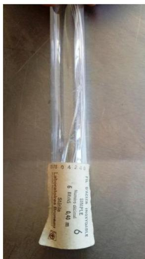
**Figure N°IV-49:** Fil métallique inoxydable de 0.4mm de diamètre monobrin, stérile.
