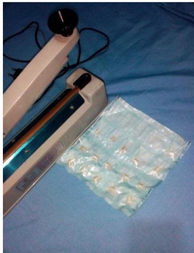
**Figure N° IV-26:** La fermeture du papier d'autoclavage à l'aide d'une soudeuse thermocollante.
