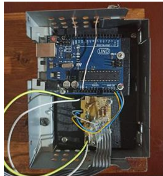
Figure III.3. Montage de la carte Arduino Uno dans son boîtier .
