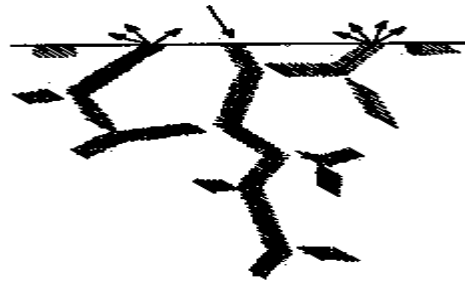
Figure.II-2 : Schéma des différentes interactions ion-solide : élastiques inélastiques.
