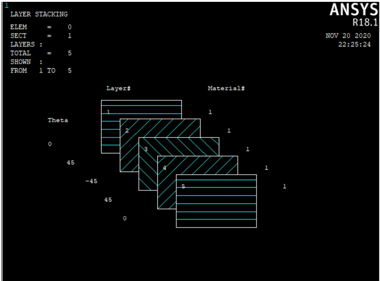
Figure III.13 Les 5 couches et leurs orientation
