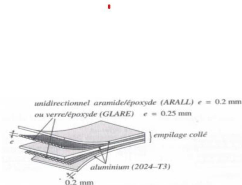
Figure I.13 : Composite à matrice métallique.
