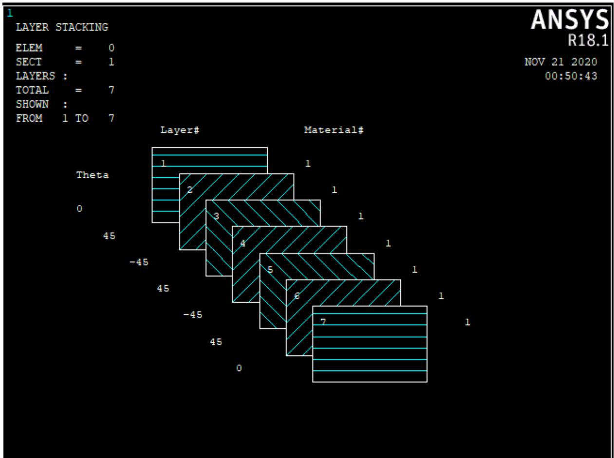
Figure III.19 Les fibres et leurs orientations
