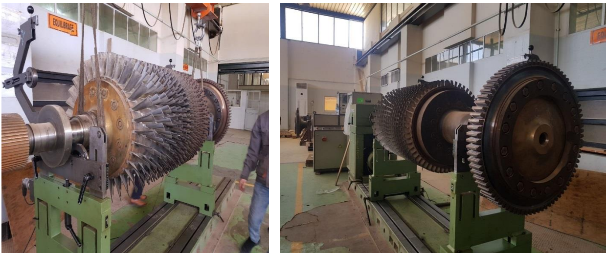
Fig 3.9 : Mise en place du rotor
