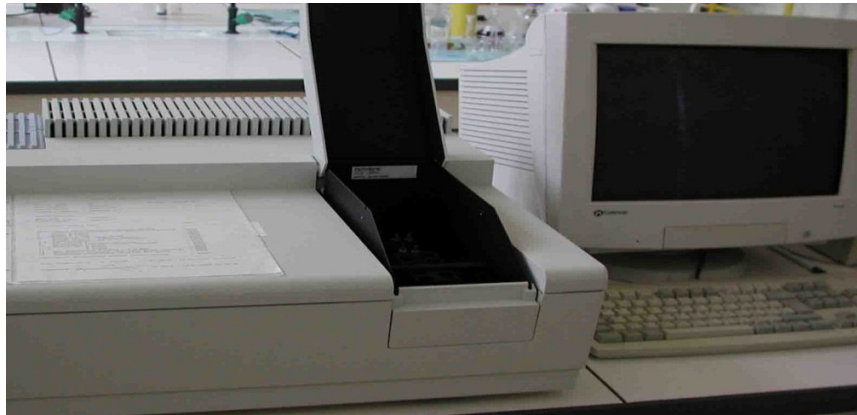
Figure III-12 :LeSpectrophotomètre Ultraviolet –Visible.
