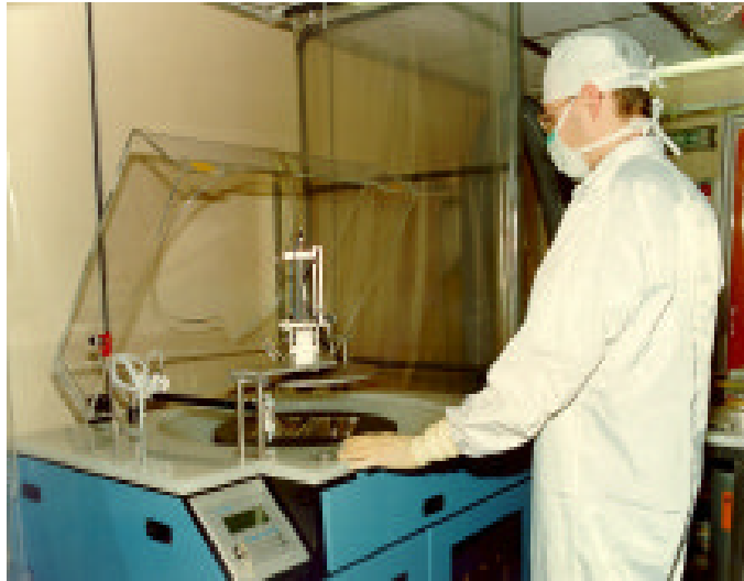
Photo III.2.Exemple de spin-coating (ou enduction centrifuge) réalisé en salle propre au Commissariat à l'Energie Atomique
