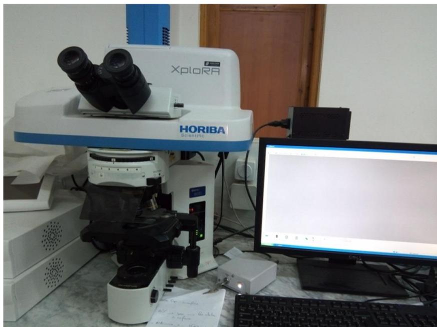
**Figure II.7 : Spectroscopie Raman**
