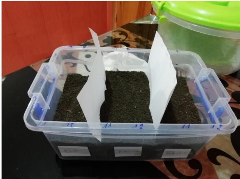
**Figure II.4 :** Essais d'enfouissement dans le sol
