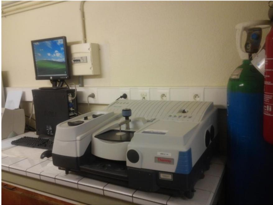
**Figure II.6 :** Spectroscopie IRTF -ATR
