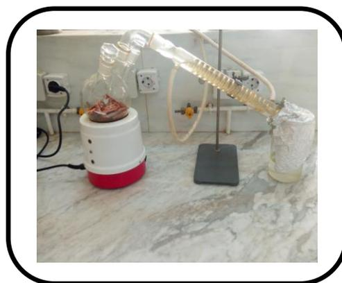
Figure 40 : Montage de l'Hydro-distillation employé pour l'extraction d'HE.
