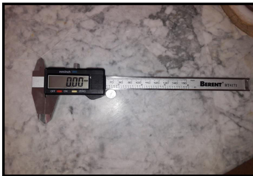
Figure 14 : Pied à coulisse électronique
