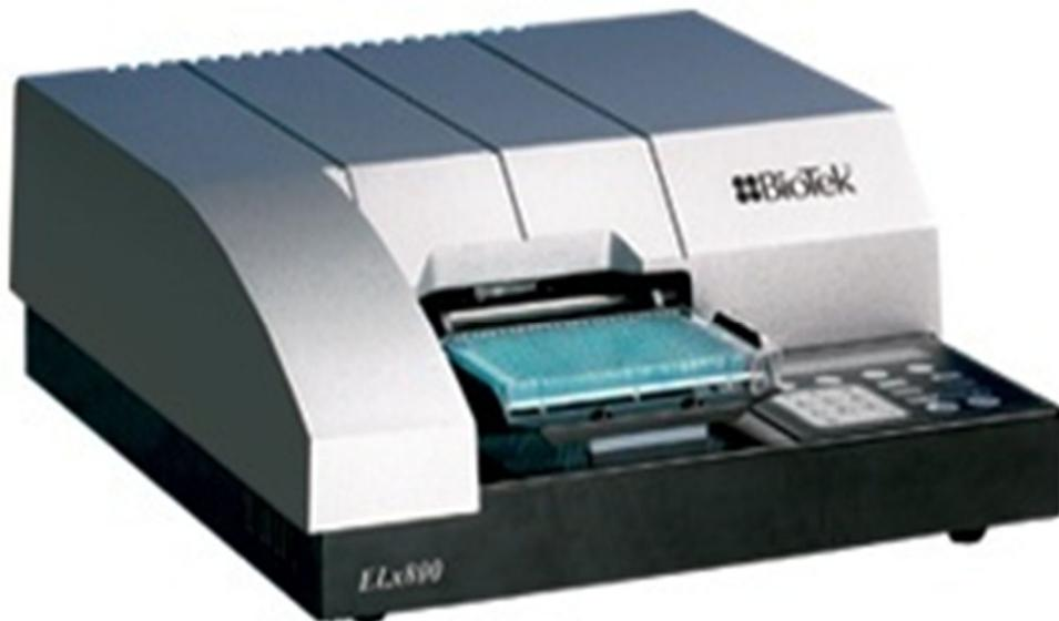
**Photo n° 10** : Spectrophotomètre ELx 800
