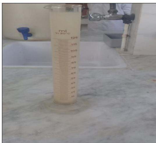
**Figure I-3.** Récupération de la Bentonite en suspension
