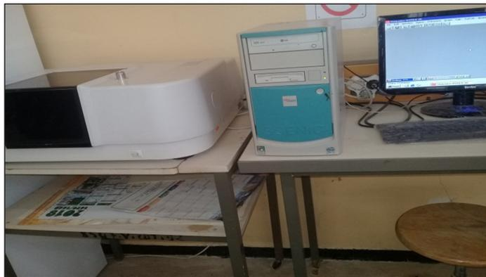
**Figure.I.8.** Appareil de spectrophotomètre Infrarouge
