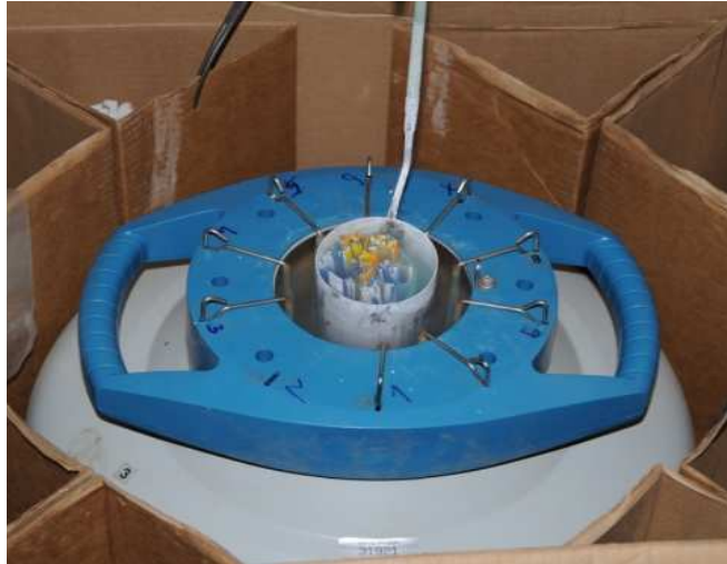
Figure N° 23: Le réservoir pour l'azote liquide dans lequel sont entreposées les paillettes (bonbonne)
