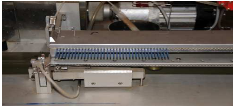
Figure N°21: La machine pour le remplissage des paillettes.
