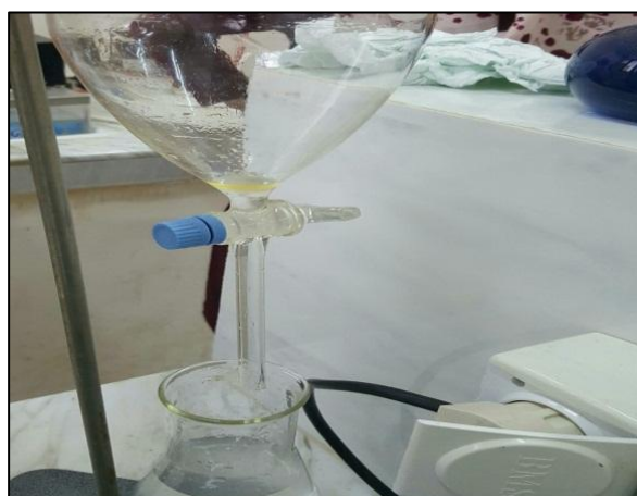
Figure 09: Procédé d'extraction et de récupération des HE (Photo Originale).
