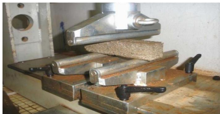
**Image 60.** Dispositif d'essai de la résistance à la traction par flexion. Crédit photo Edouard Kadjile.
