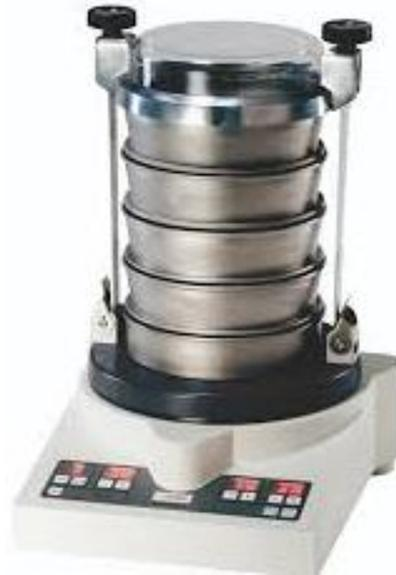
**Image 45.** Tamis d'analyse granulométrique.
