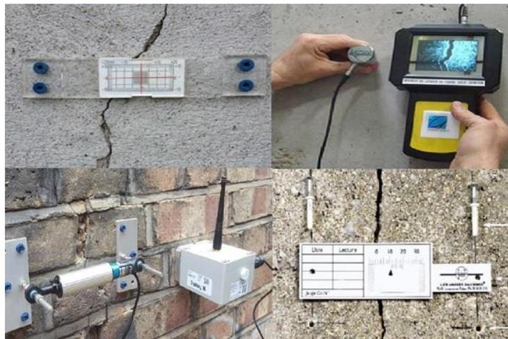
**Image 40.** Différents types de fissuromètres. Source : internet
