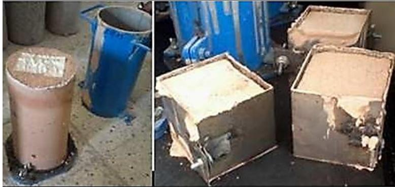
**Image 52.** Moules cylindriques et cubiques utilisés pour le coulage des échantillons de notre composition d'argile prélevée de Timimoun. Source : Lamouri Hafsa.
