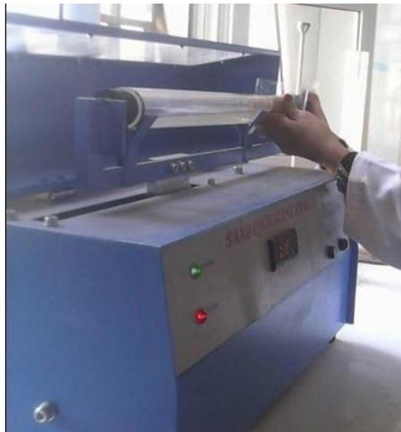
**Image 58.** Agitatrice électrique pour l'agitation des éprouvettes de l'essai ES. Laboratoire de génie civil, université d'Adrar. Source : Lamouri Hafsa.
