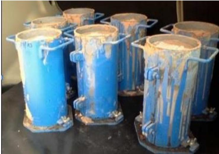
**Image 53.** Moules cylindriques utilisés pour le coulage des échantillons de notre composition d'argile prélevée d'Adrar. (Source : Mme Lamouri Hafsa Hannani)
