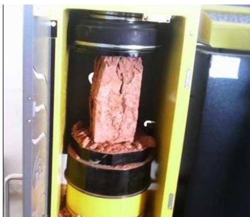
**Image 51.** Essai de compression pour une brique d'adobe. Source : Lamouri Hafsa.
