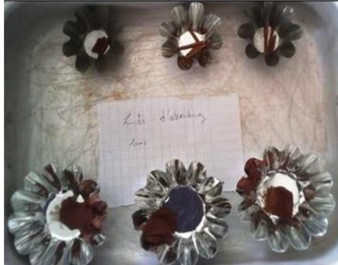
**Image 56.** Echantillons préparés pour la détermination des limites d'Atterberg.
