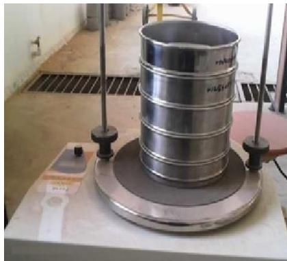
**Image 54.** Série de tamis pour la réalisation de l'essai de l'analyse granulométrique.
