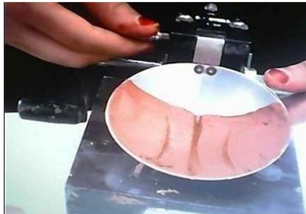
**Image 55.** Appareil de Casagrande pour la détermination de la limite de liquidité. Laboratoire de génie civil, université d'Adrar. Source : Lamouri Hafsa.
