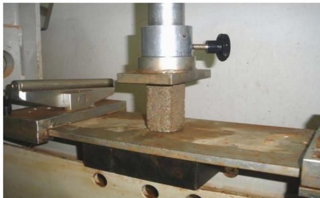
**Image 61.** Dispositif d'essai de la résistance à la compression. Crédit photo Edouard Kadjile.
