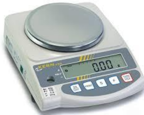
Figure III.4. Balance électronique KERN 1500 g d'une précision de 0.01g
