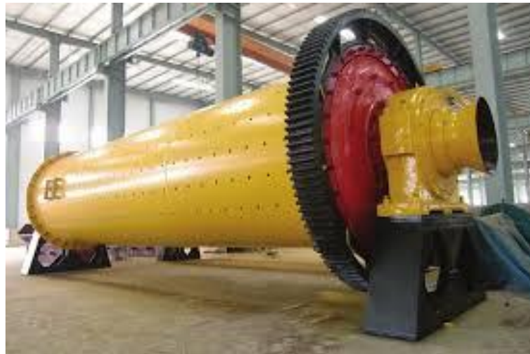
Figure I.1. Vue extérieure d'un broyeur à boulets
