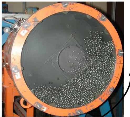
Figure II.14. Test d'abrasion avec broyeurs à boulets de laboratoire
