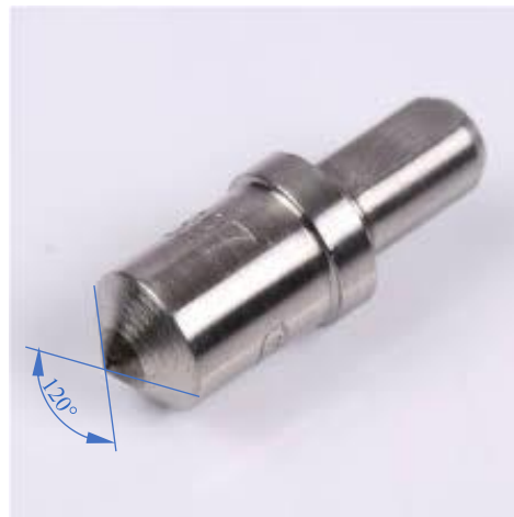
Figure III.6. Pénétrateur conique utilisé dans un duromètre Rockwell
