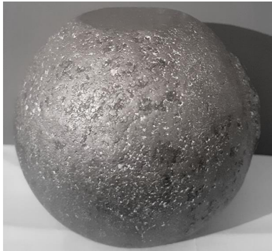
Figure III.13. Usure abrasive des boulets à la fin des essais
