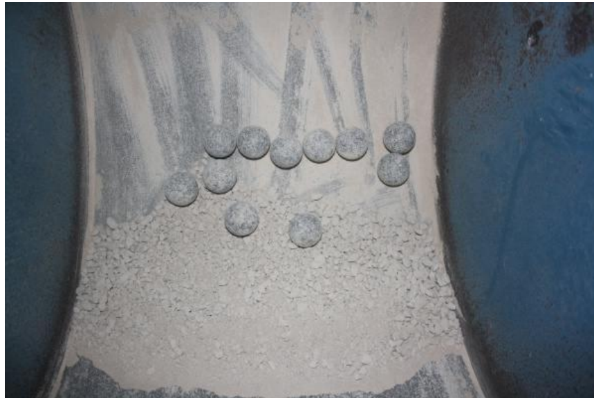
Figure III.3. Charge abrasive à l'intérieur de la machine Los Angeles
