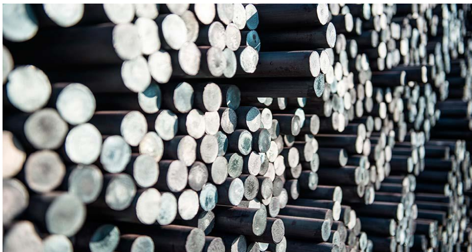
Figure I.5. Barres circulaires pour le forgeage des boulets
