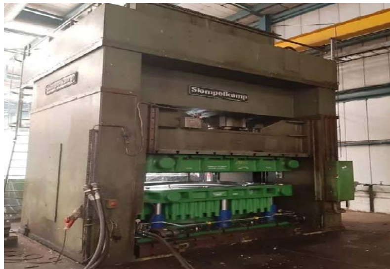
Figure I.11 Image d'une machine d'emboutissage des fonds et brise âme.
