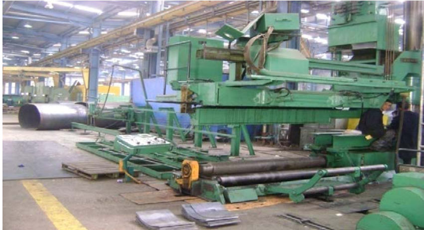
Figure I.12 Image d'une cintreuse pour former les corps de citernes.
