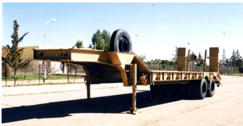
Figure I.5 Image d'une semi-remorque porte engin.
