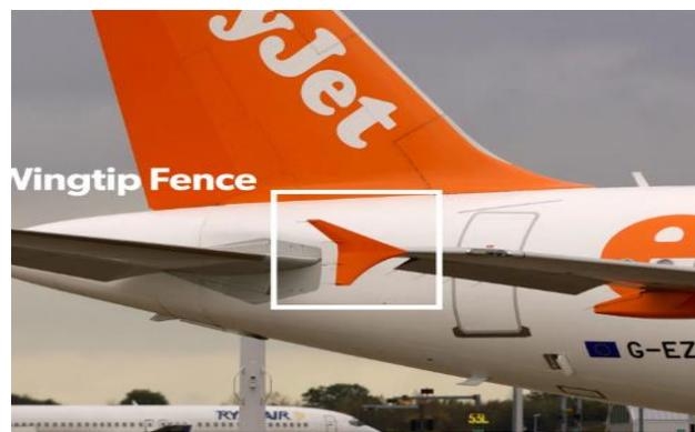
Figure I.19: Clôtures en bout d'aile
