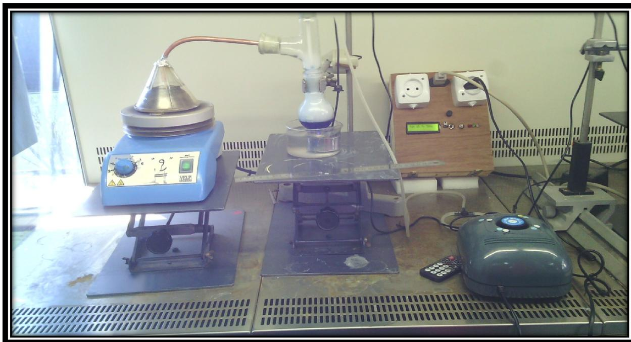
*Figure II-8 Schéma simplifié du banc de dépôt de couches minces par la technique de Spray-pyrolyse ultrasonique.*
