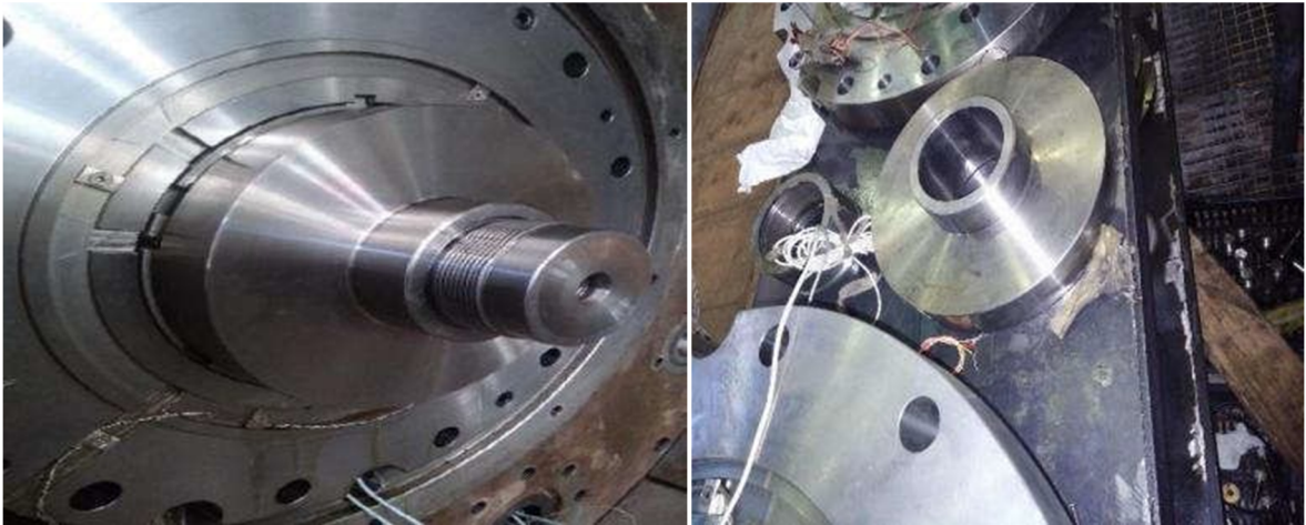
Figure 5.7 : Démontage le disque de butée par pression.
