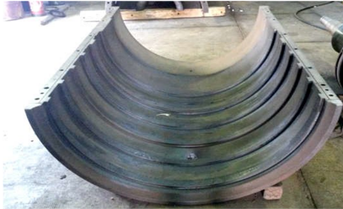
Figure 3.20 : Le corps de compresseur en forme de barillet (Partie inférieure).
