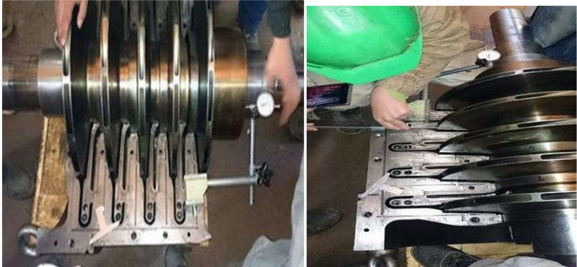
Figure 5.17 : Centrage du rotor.
