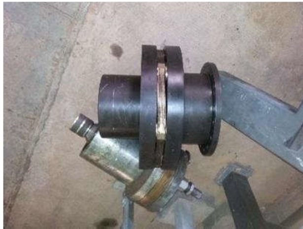
Figure 5.5 : Trappe et l'accouplement Démonté.
