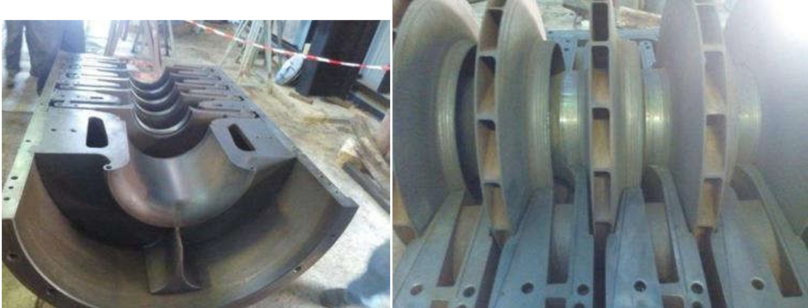
Figure 5.16 : Remontage les diaphragmes et le rotor.
