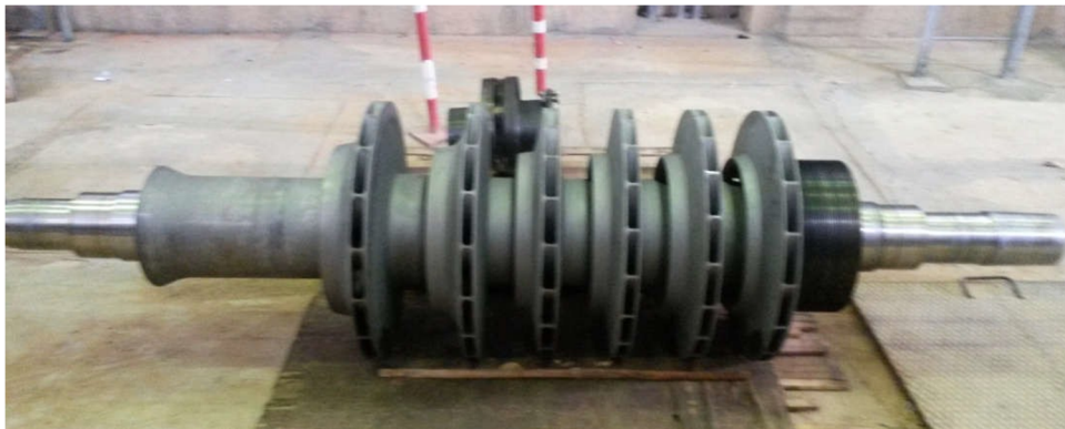
Figure 3.25 : Rotor du compresseur centrifuge.
