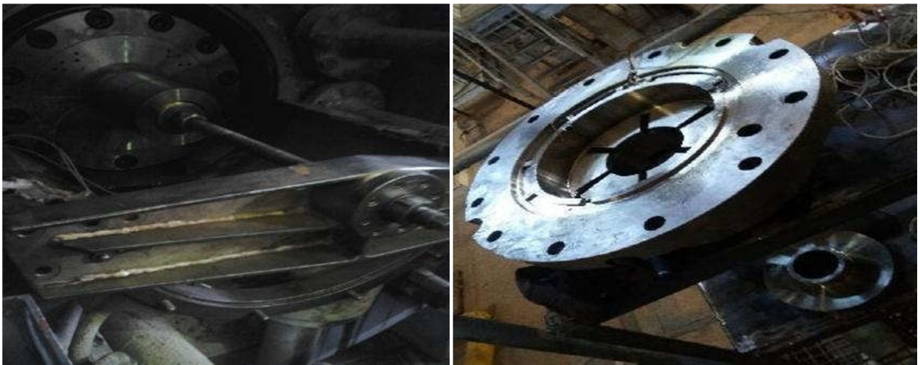
Figure 5.6 : Palier de butée actif Démonté.
