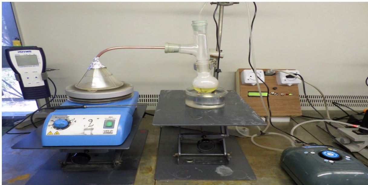
Figure II-8: Schéma simplifié du banc de dépôt de couches minces par la technique de Spray-pyrolyse ultrasonique.
