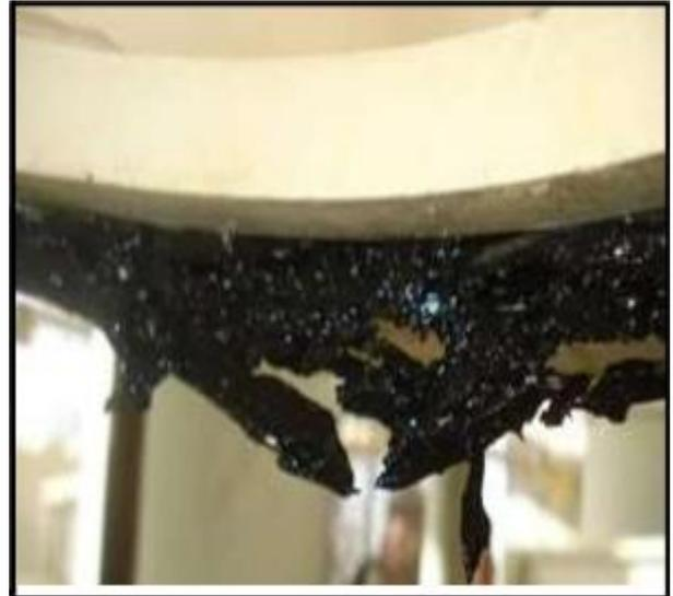
*Figure III-5 chute d'un transformateur [20]. Figure III-6 Joint de traversée écrasé [3].*
