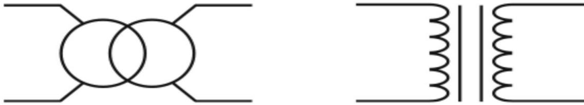
*Figure II-3* Symbole de transformateur de puissance [12].
