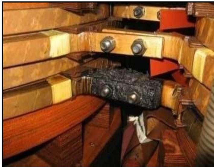
*Figure III-11 Point chaud sur connexion boulonnée [17].*
