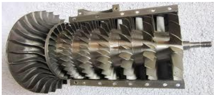
Figure I.4 : Vue d'un compresseur axial à 6 étages
