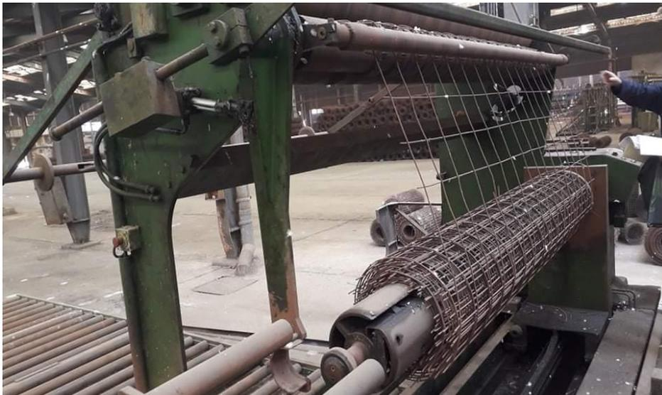
**Fig. 2.11 Dispositif enrouleur de treillis soudé**
