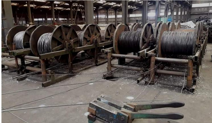
**Fig. 2.4 Dévidoirs pour fils de chaîne**
