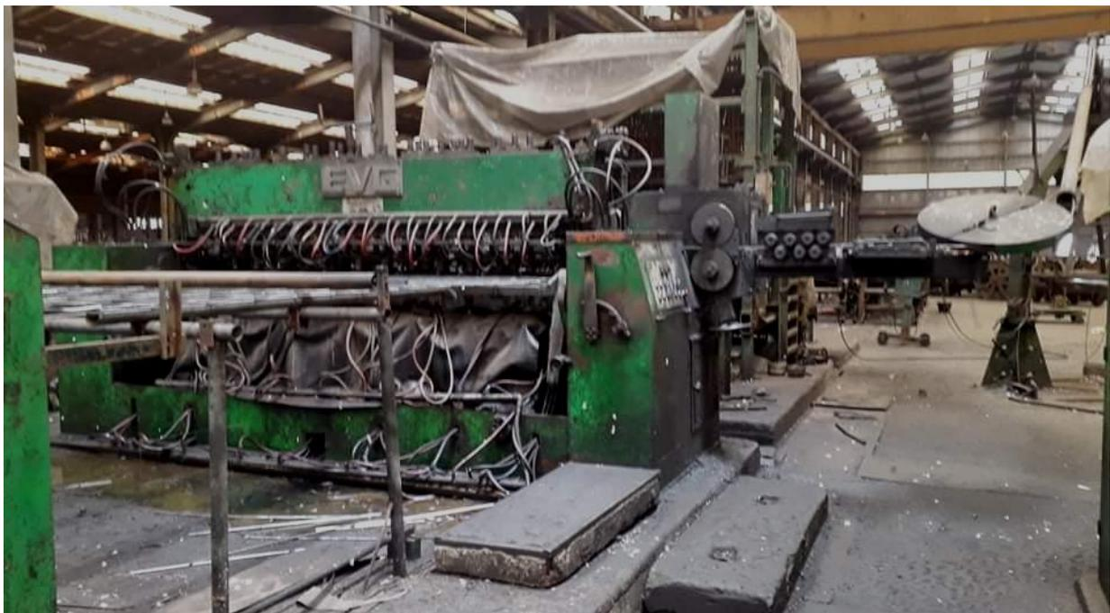
Fig. 2.3 Ligne de fabrication du treillis soudé SOTREFIT
