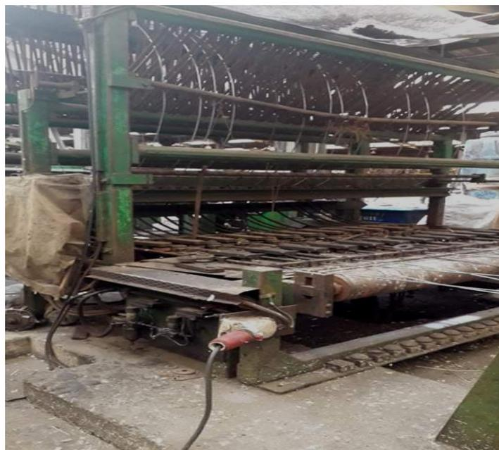
**Fig. 2.5 Dispositif d'avance des fils**
