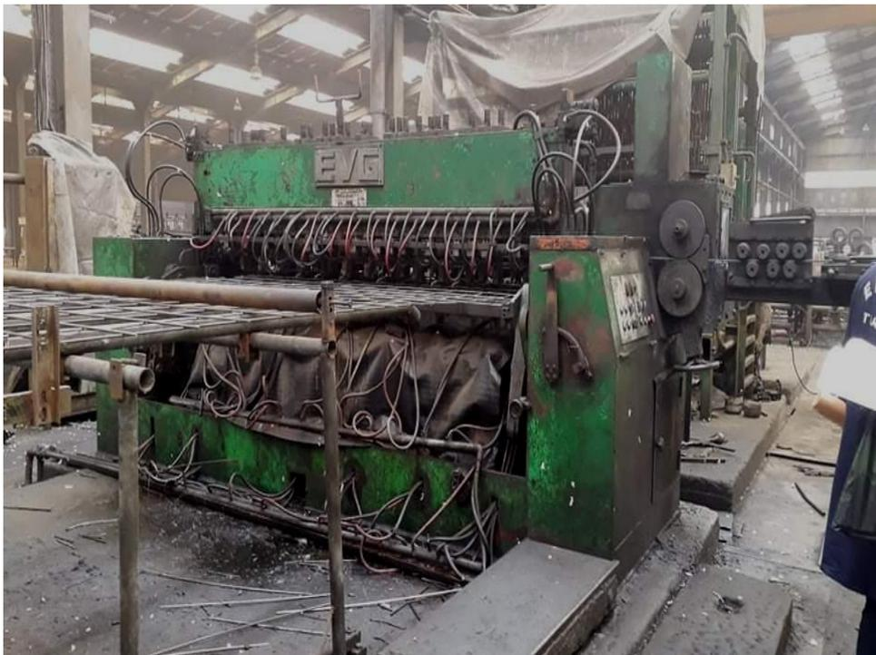
**Fig. 2.8 Soudeuse de treillis EVG G45**
