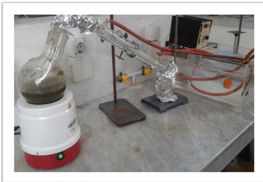
**Fig. 11** : Montage d'extraction de l'huile essentielle par hydro-Distillation (Photo prise le 25/03/2019)
