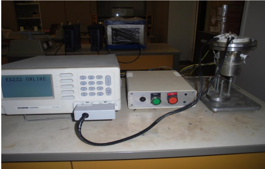
Figure IV.1 : Impédance mètre GWINSTEK,LCR-821
