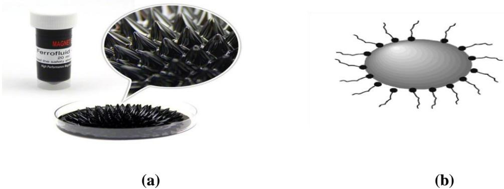
**Figure I.14.** : (a) Comportement d'un ferrofluide lorsqu'un champ magnétique est appliqué [17] ; (b) La couche de surfactant autour d'une particule d'un ferrofluide [18].
