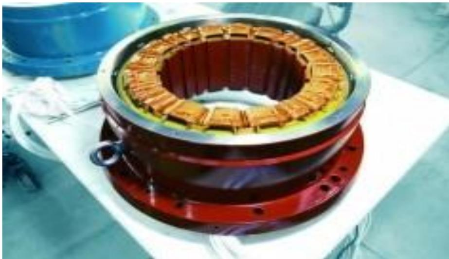
**Figure I.6 :** Palier magnétique [8]
