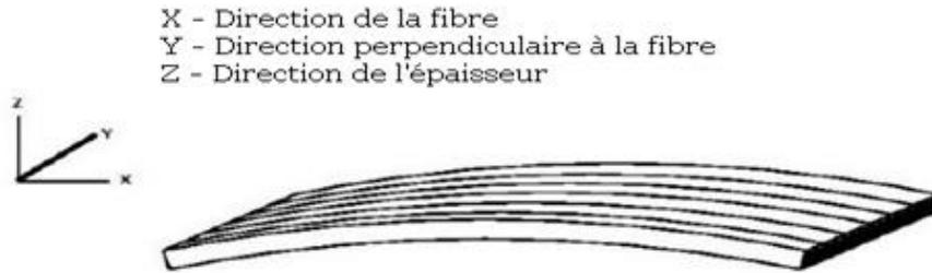
Figure II.1: Système de coordonnées de la poutre incurvée.
