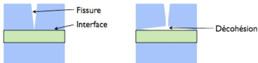
**Figure I.8:** Le rôle de l'interface sur la ténacité des composites ; (a) lorsqu'une fissure atteint l'interface, (b) elle est déviée.
