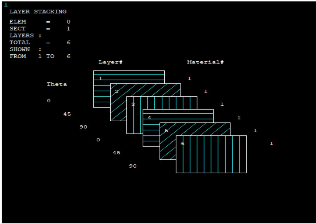
Figure III.1 Les couches utilisées dans le 1<sup>er</sup> avec leurs orientations.
