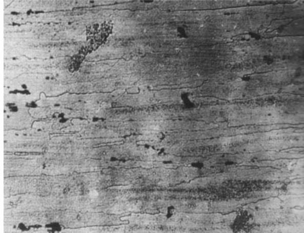
**Fig. III.1.** Microstructure de l'alliage 7075 à l'état T4, (G = 200).
