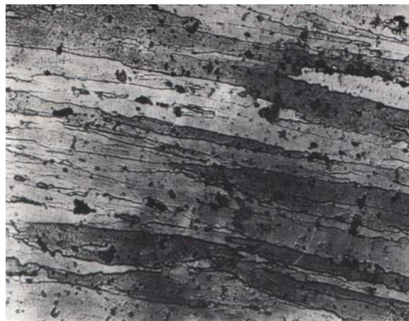
**Fig. III.3.** Microstructure de l'alliage 7075 à l'état T73, (G = 200).
