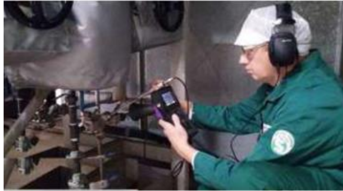
Figure I.7: Contrôle ultrasonique d'un moteur. [4]
