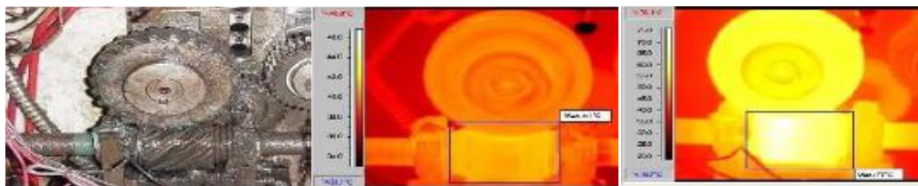
Figure I.5: Défaut d'engrenage Avant et après correction. [7]
