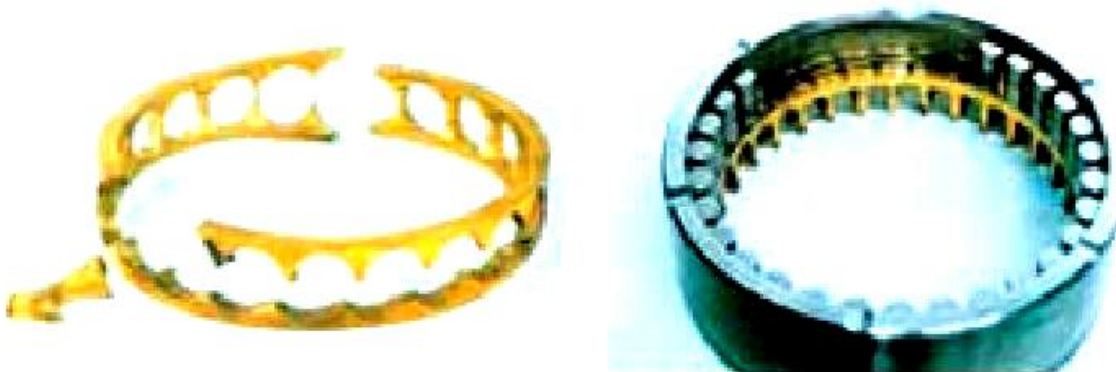
Figure III.8 : détérioration de cage.
