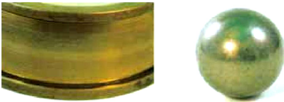
Figure III.17 : Taches et décoloration.
