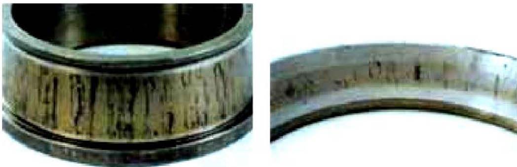
Figure III.11 : corrosion des pistes.
