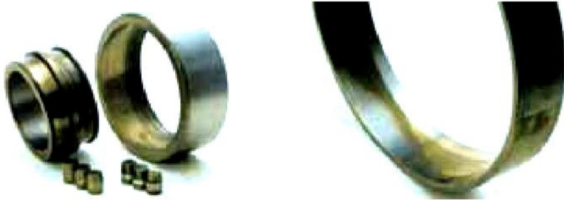
Figure III.9 : Déformation du chemin de roulement.
