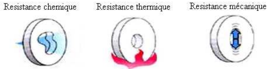
Figure-3: Différentes contraintes qui agissent sur la buse.
