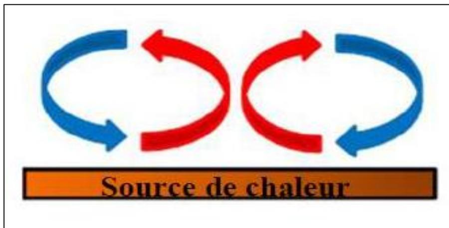
**Figure I- 5 :** Schéma représentatif de la convection naturelle (R. Leleu, 1992).
